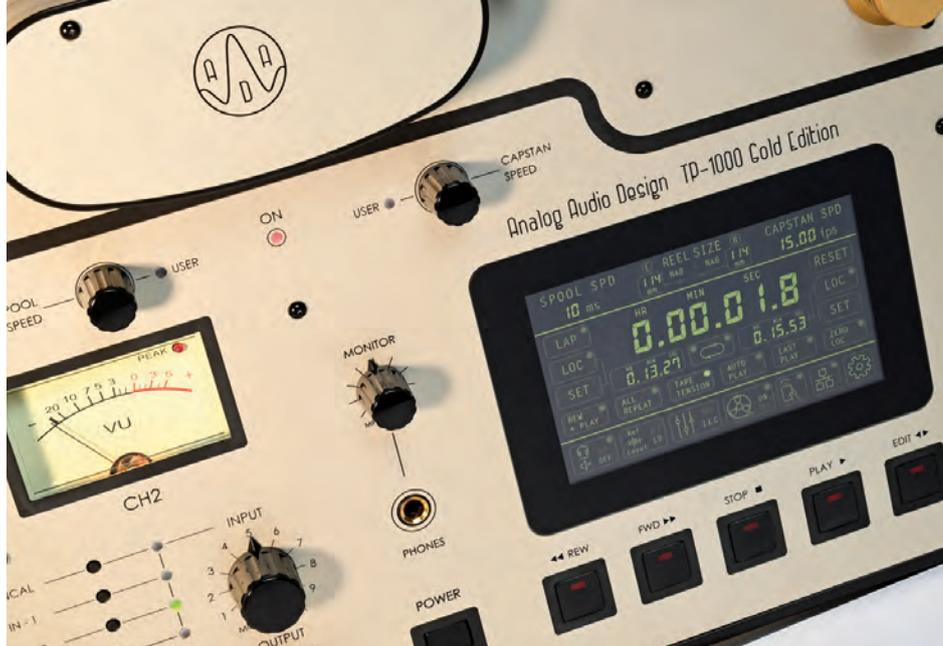
sorties Ligne sont toutes symétriques, avec possibilité de modifier le gain via l'interface ; 2 gains sont programmés : 4 dBu (norme Pro) ou -10 dBV (hi-fi). Les potentiomètres Analog Device 5293 sont de type analogiques à commande numérique.
